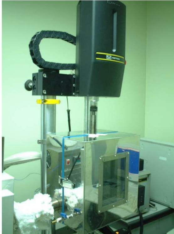
圖 4-7 溫度/溼度控制箱搭配微拉伸試驗機
