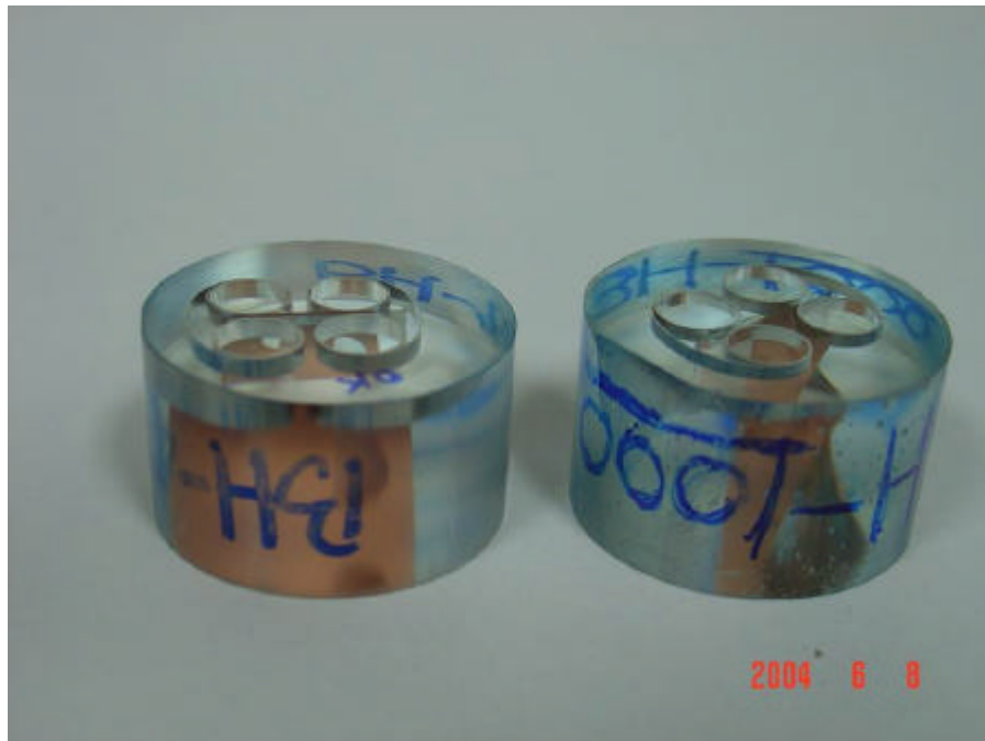
圖 5.28 純膠材接著組合試片冷埋後的試片圖
