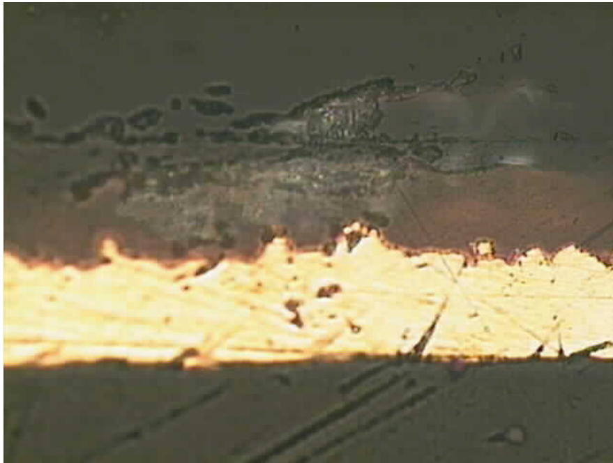
圖 5.32 純膠材在 85°C/85%RH 老化 72 小時之試片橫截面圖
