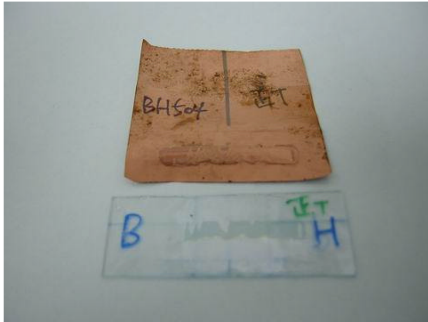
圖 5.55 純膠材高溫高濕老化 500 小時後斷面圖
