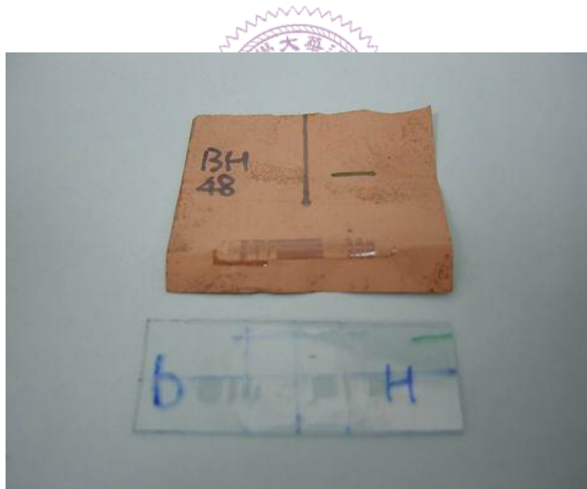
圖 5.54 純膠材高溫高濕老化 48 小時後斷面圖
