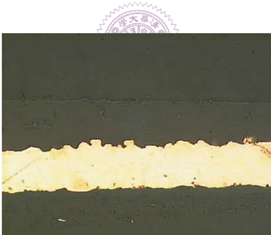
圖 5.28 純膠材接著組合試片冷埋後的試片圖
