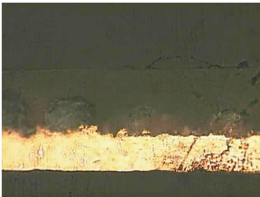
圖 5.30 純膠材在 85°C/85%RH 老化 24 小時之試片橫截面圖
