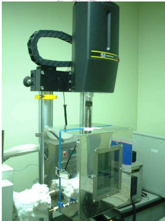
圖 4-3 Instron-8848 微拉伸試驗機與溫/溼度控制箱
