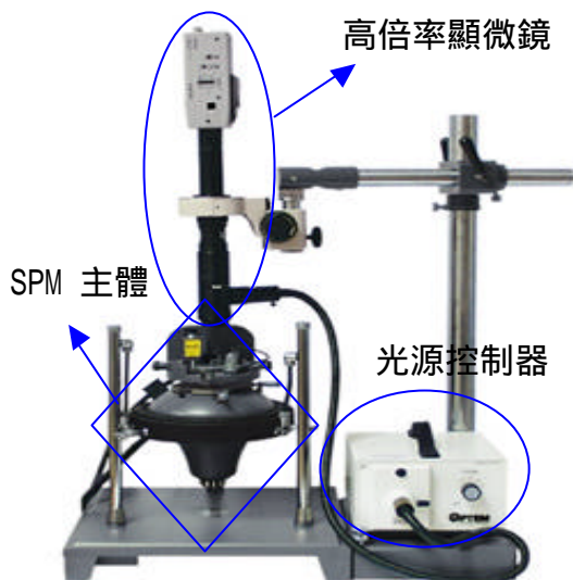
圖 3.1.1 本實驗之掃描式探針顯微鏡裝置圖
