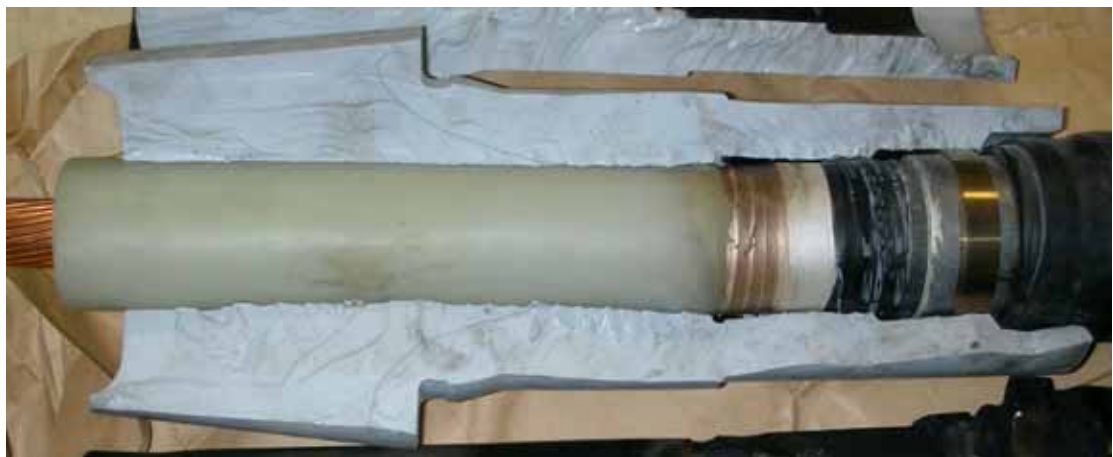
圖5.3-3 面板廠使用之預鑄式電纜終端實體
