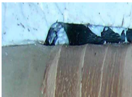
圖5.3-16 應力錐前端凹槽邊緣之縫隙 圖5.3-17 應力錐前端凹槽銀漆殘留狀況
