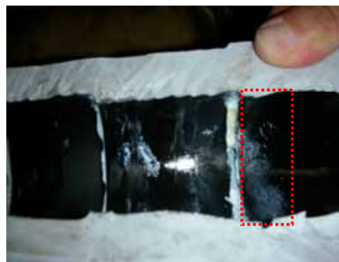
圖5.3-16 應力錐前端凹槽邊緣之縫隙 圖5.3-17 應力錐前端凹槽銀漆殘留狀況
