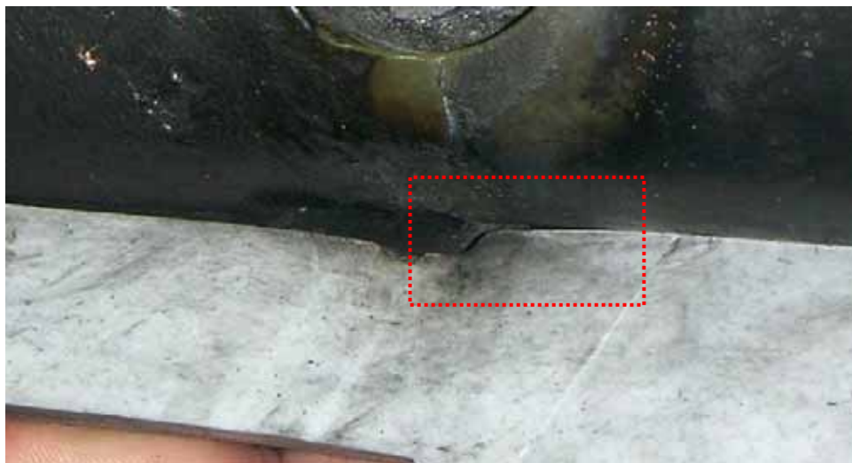
圖5.3-10 應力錐最前端凹槽邊緣之縫隙
