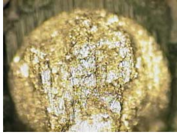
圖 6.33 Sn-3.5Ag 在 0 小時時效作用之破壞表面
