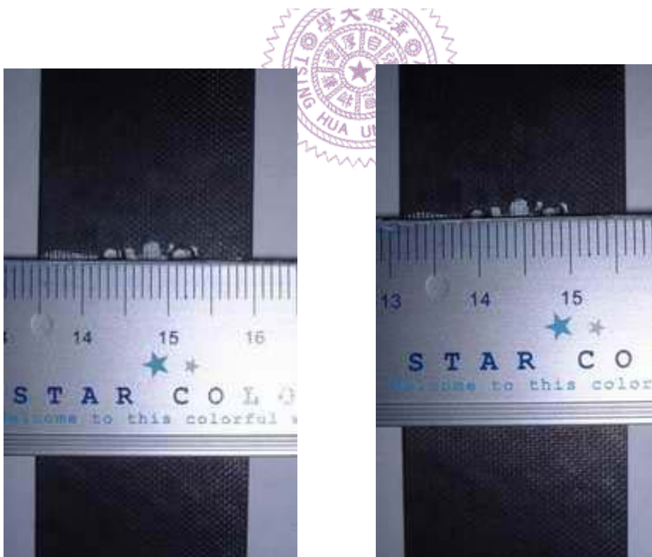
圖 3-11 孔距 8mm 之單邊貼片修補試片圖
