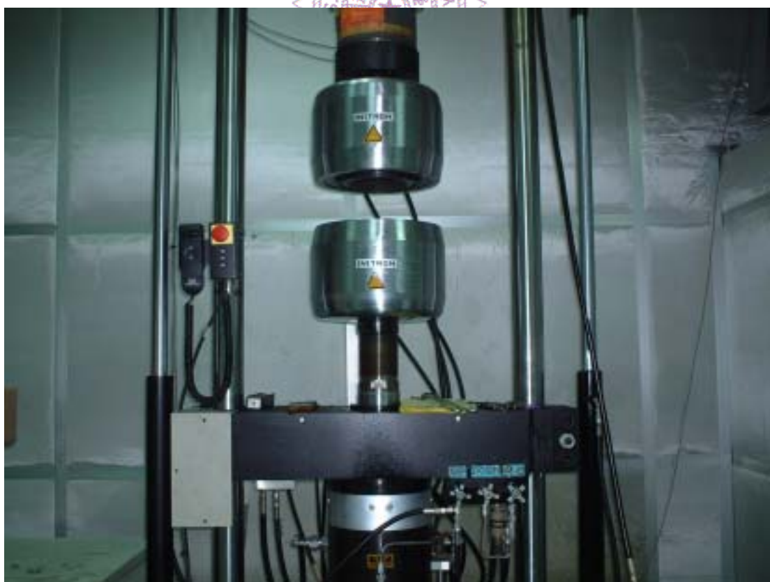
圖 3-2 Instron-1322 型動態萬能試驗機夾頭
