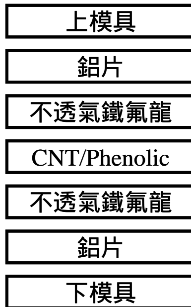
圖 4-6 CNT/phenolic resin 熱壓成形試片與模具疊層圖
