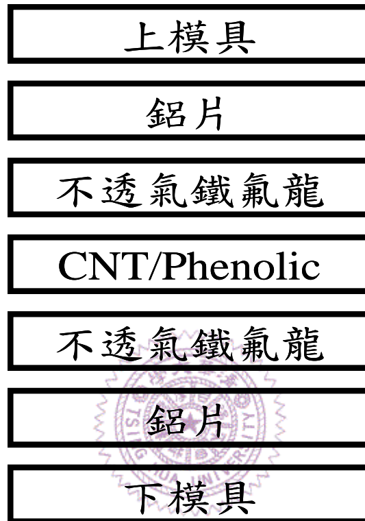
圖 4-14 CNT/phenolic resin 熱壓成形試片與模具疊層圖
