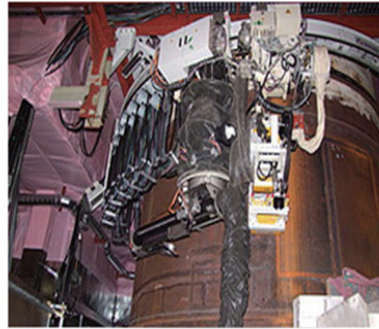
▲圖11.切割熱交換器用的隔離切割設備
