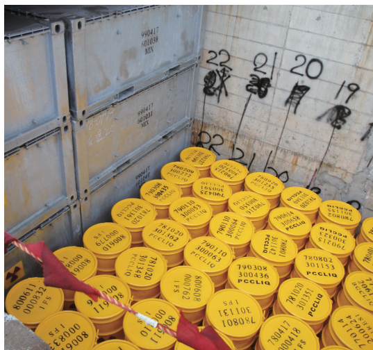
▲ 檢整重裝後的廢料桶，及重裝容器回貯於壕溝內的狀況
