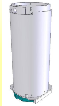
傳送護箱 外徑：2.12 米 內徑：1.72 米 高：5.13 米 重：46.18 噸
