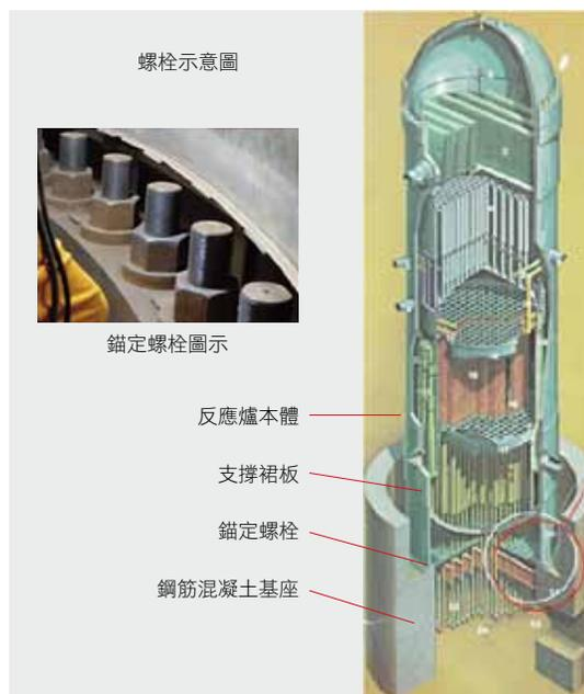
▲圖 1 核二廠 1 號機反應爐支撐裙板錨定螺栓示意圖
