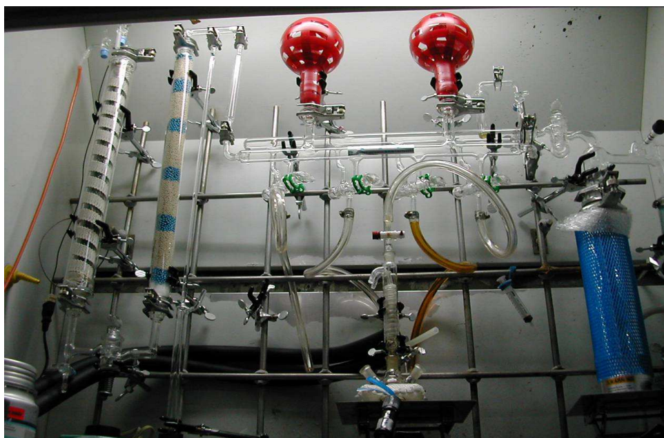
圖 3-1 傳統熱迴流化學合成系統
