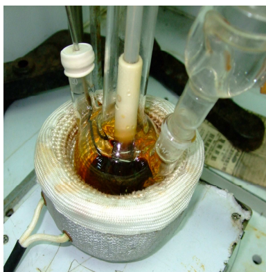
圖 3-6 套上加熱包開始加熱
