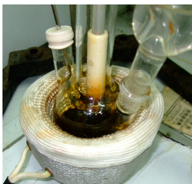
圖 3-5 熱迴流時，溶液與粉末的顏色
