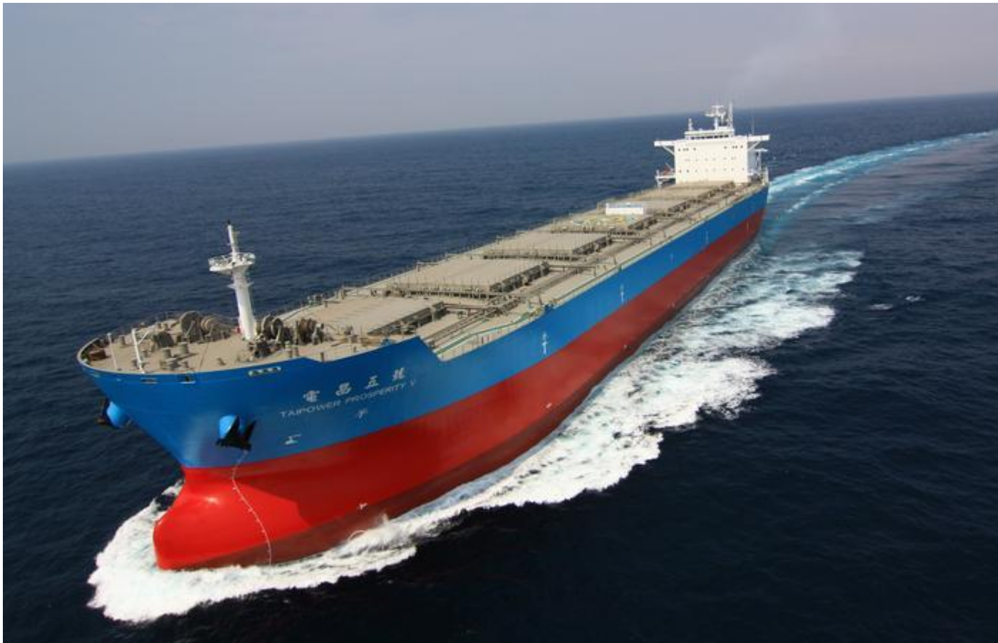
電昌五號 運煤船 載運量 93,300噸 全長234.8 m, 寬 38 m
