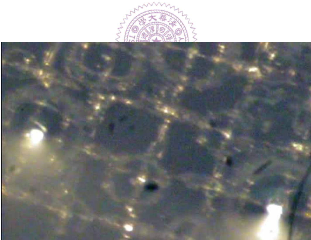
Fig. 4.8 顯微鏡下氣泡被不銹鋼網鎖住之現象
