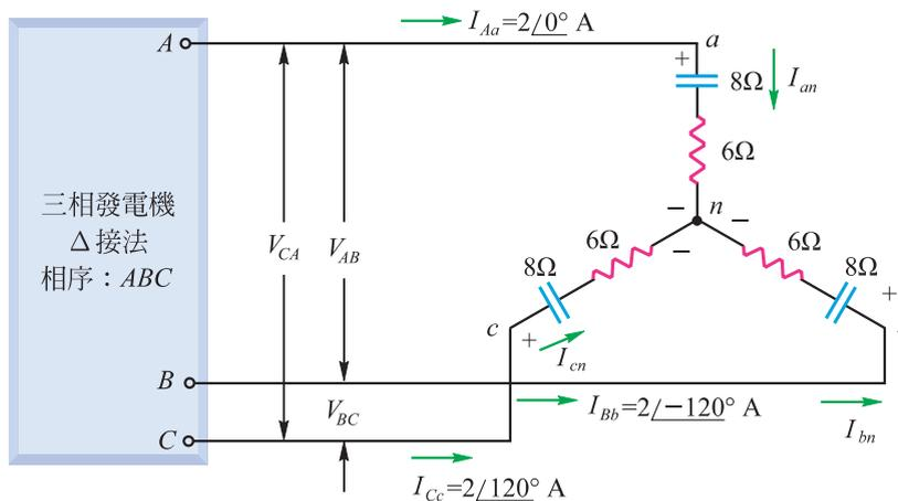
■ 圖 12-22 三相系統 Δ-Y 接法
