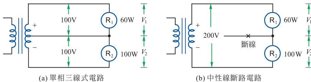
■ 圖 12-3 中性線斷路電路
