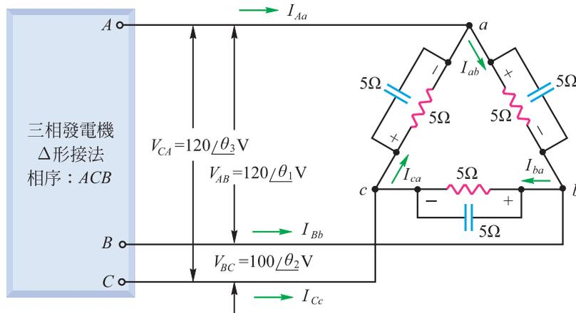
■ 圖 12-21 三相系統  $\Delta$ - $\Delta$  接法
