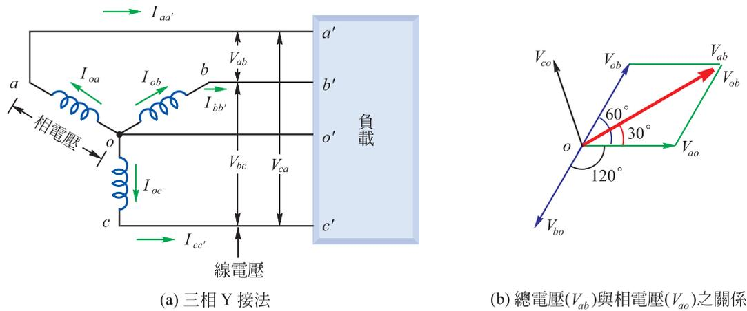
■ 圖 12-10 三相 Y 形接法電路
