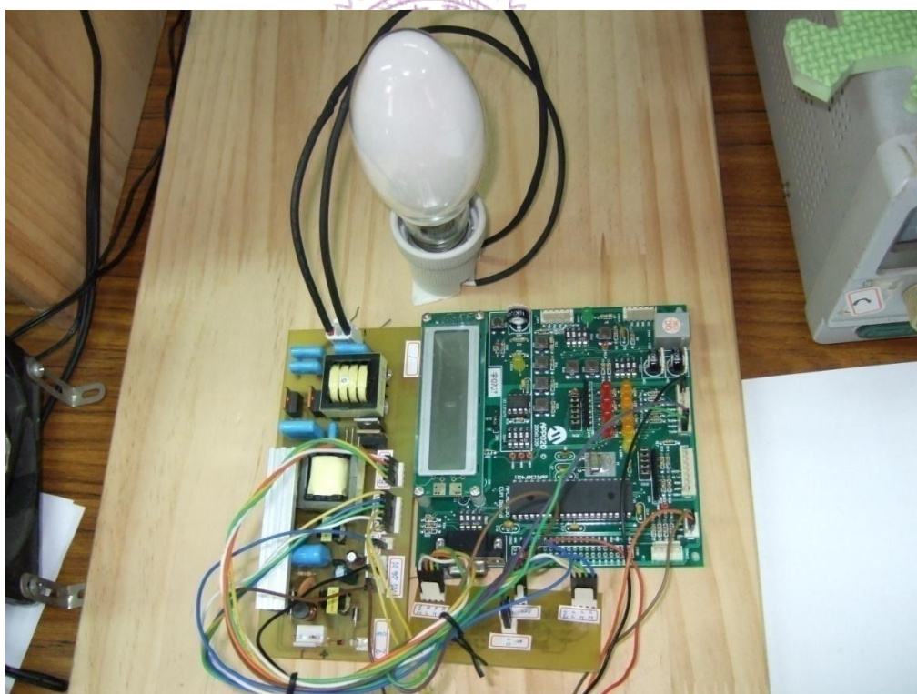
圖 4-28 複金屬燈數位式電子安定器電路雛形
