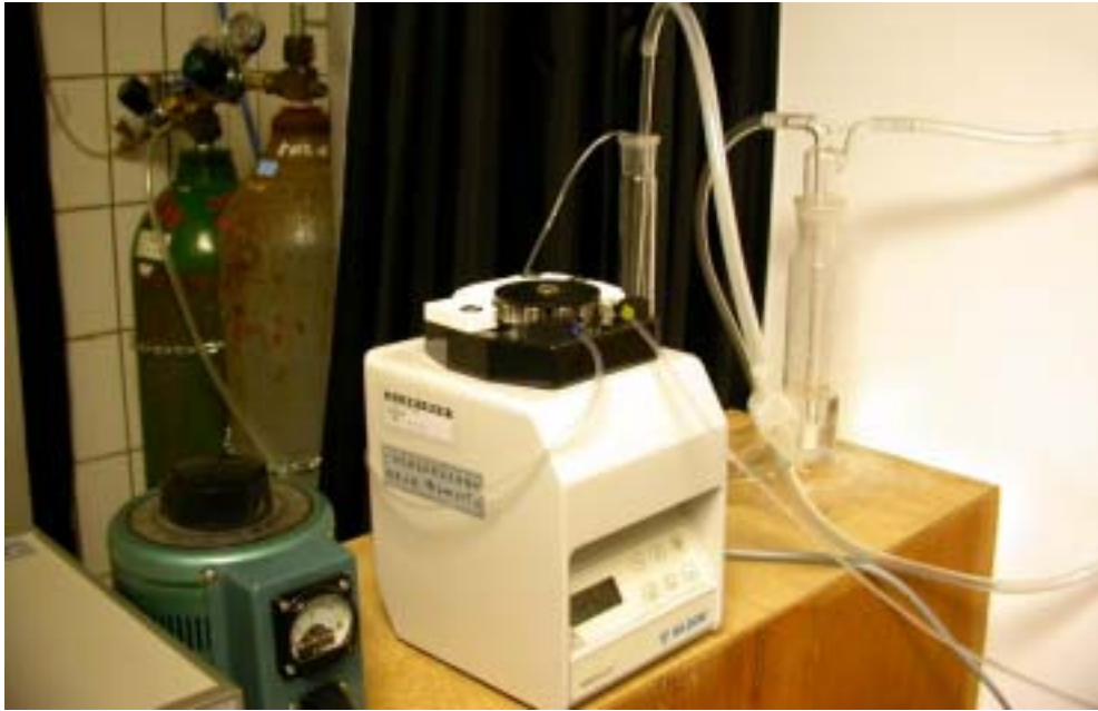
圖 2-21 供給細胞養分並維持恆溫與 PH 值之系統
