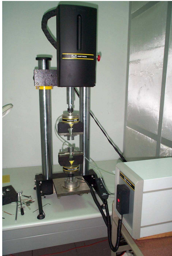
圖 4.3 Instron 8848 微拉伸測試機
