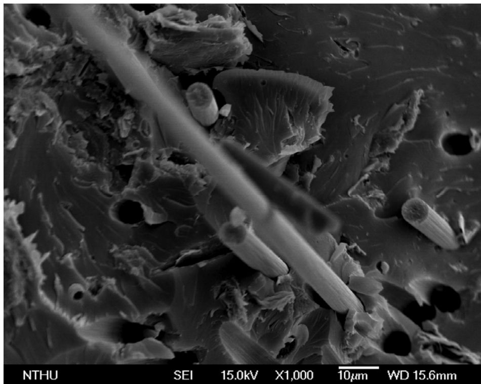
圖 5-12 碳化前添加 0phr 六羰鉬之破壞斷面圖
