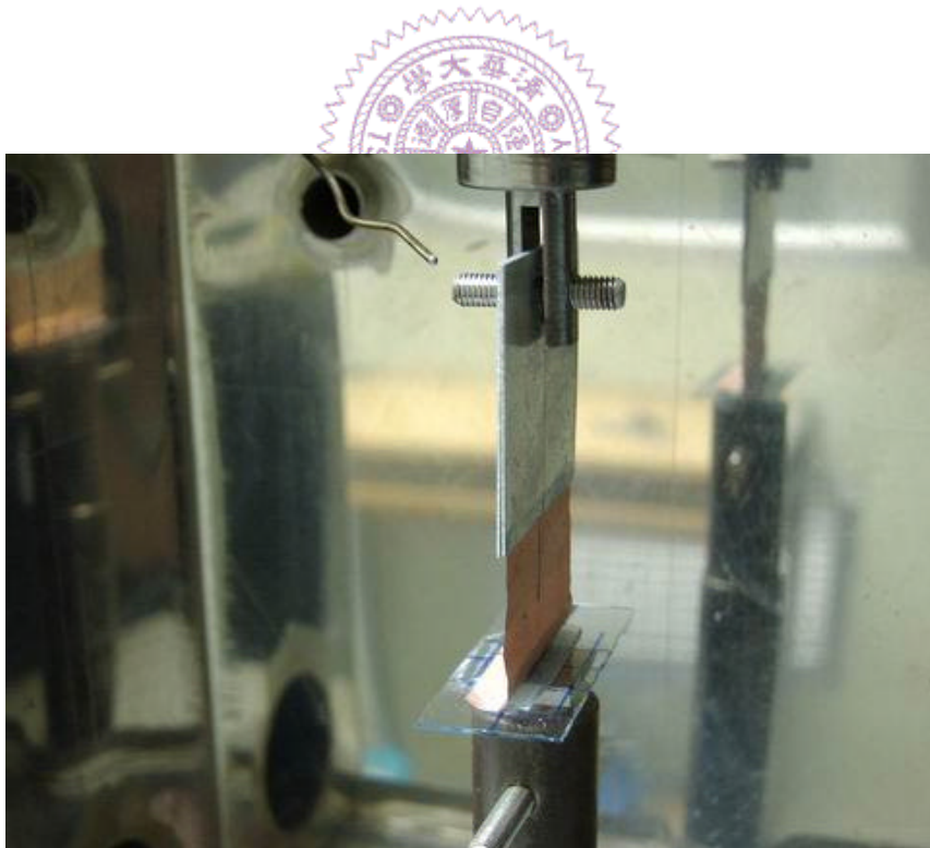
圖 4.17 接著組合試片撥離測試圖（二）
