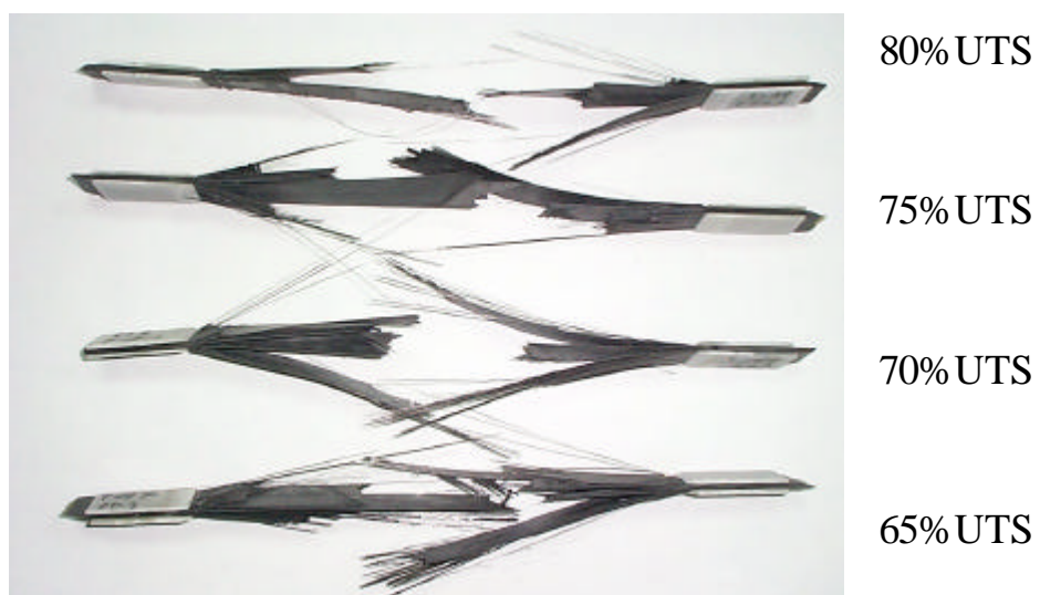
圖 4-87 試片經扭轉作用及 60°C, 90%RH 處理再經低能量衝擊 之疲勞破壞側面照片圖
