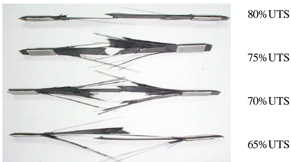
圖 4-88 試片經低能量衝擊及扭轉作用再經 60°C, 90%RH 處理 之疲勞破壞側面照片圖
