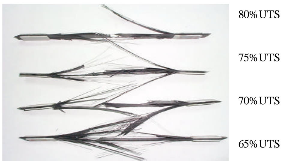
圖 4-84 試片經 60°C, 90%RH 處理再經低能量衝擊作用之疲勞破壞 側面照片圖
