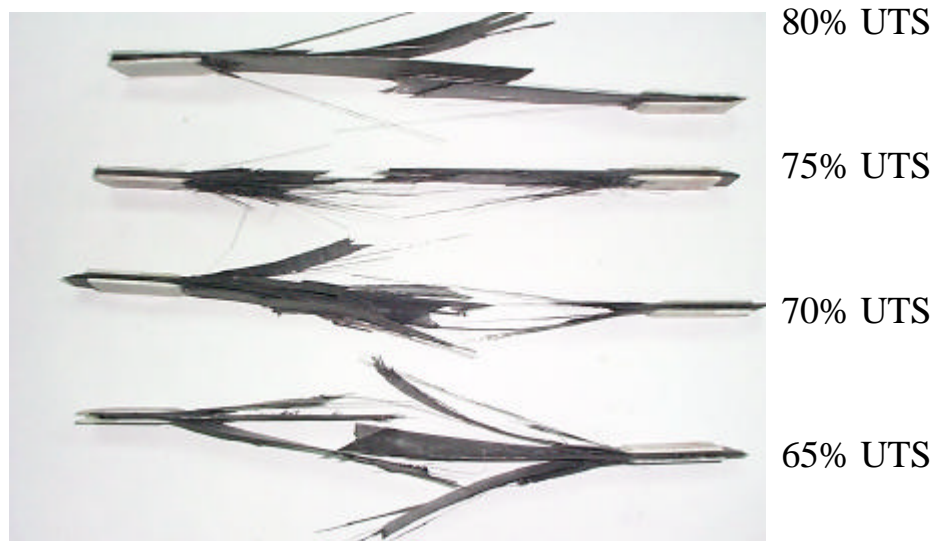
圖 4-85 試片經低能量衝擊作用再經 60°C, 90%RH 處理之疲勞
