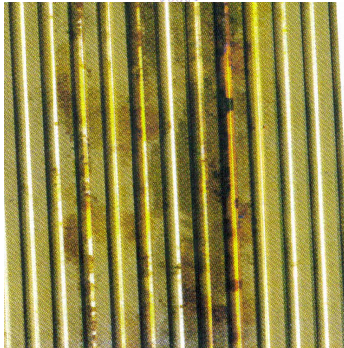
圖 3-2 不鏽鋼導電雙極板在燃料電池長時間使用，產生腐蝕作用 [15]
