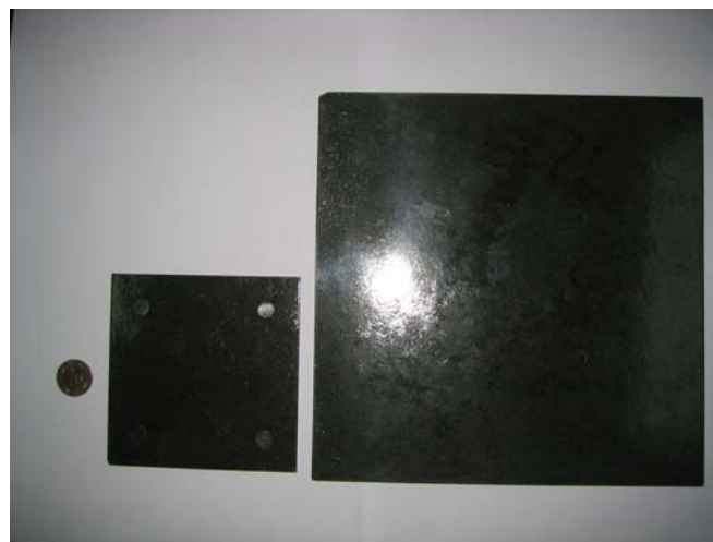
圖 4-13 左為 10*10cm 經熱壓成型雙極板，圖右為 20*20cm 經熱壓成型雙極板
