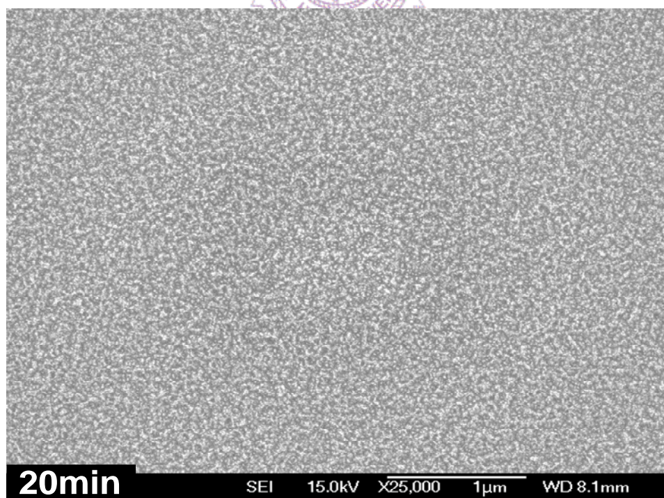
圖 5.56 \text{SiO}_x 經 20min 氬電漿處理之 FEGSEM 形貌圖
