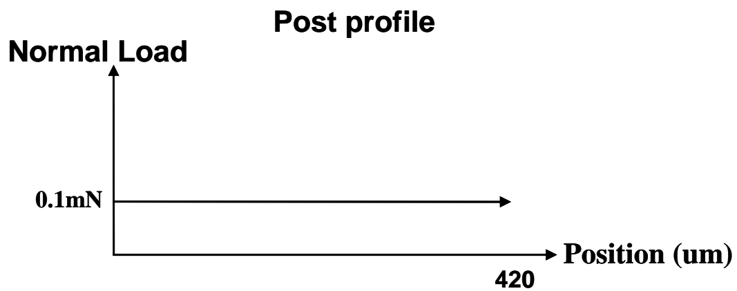
圖 4.7 標準刮痕試驗之流程圖
