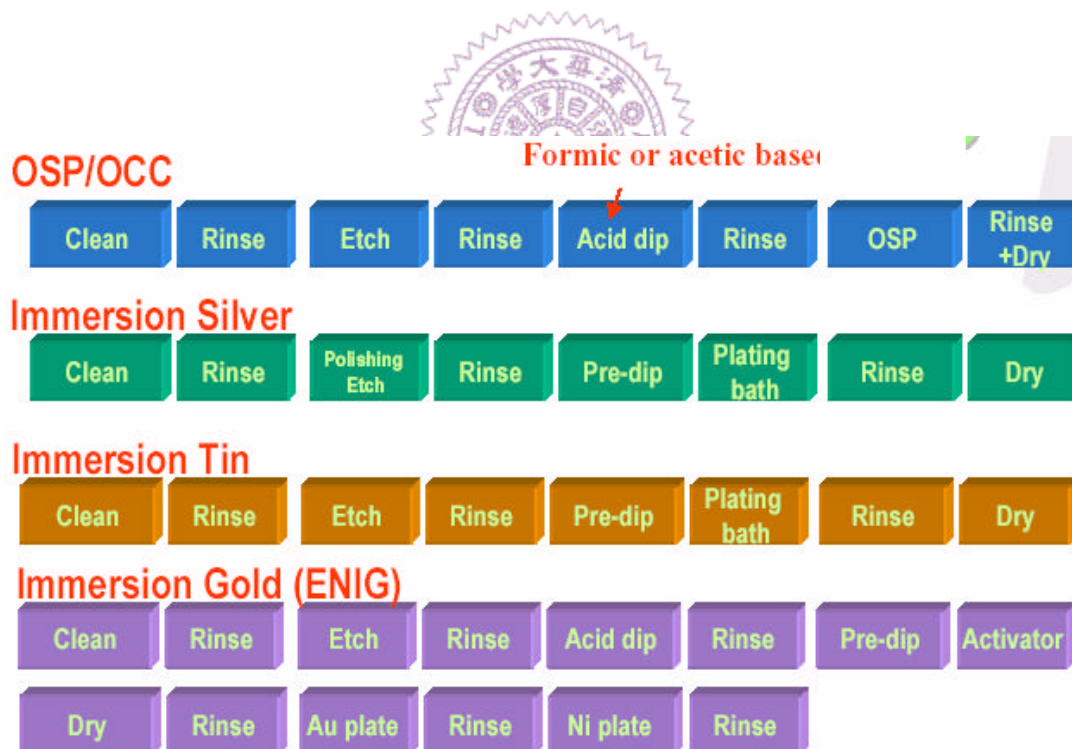
圖 3.1 PCB 不同表面處理的製造流程[6]
