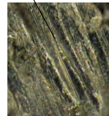
b. 結構體端的錫球斷面
