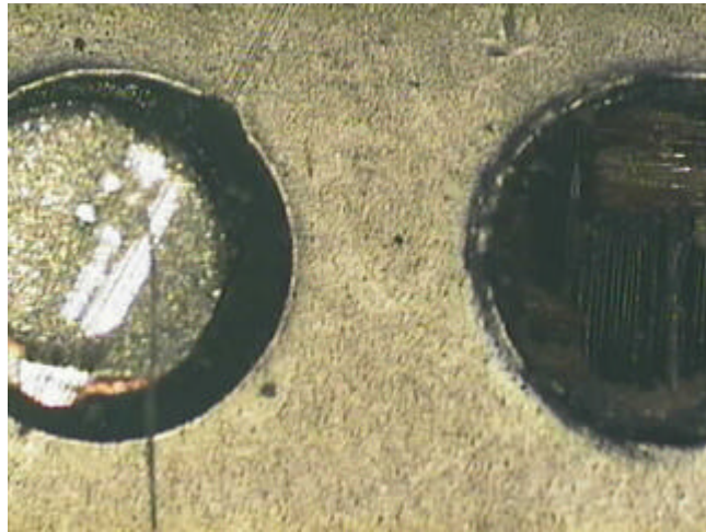
圖 5.6 第一次改進的試片上，右邊是壞在錫球，左邊則是壞在焊墊與銅箔面
