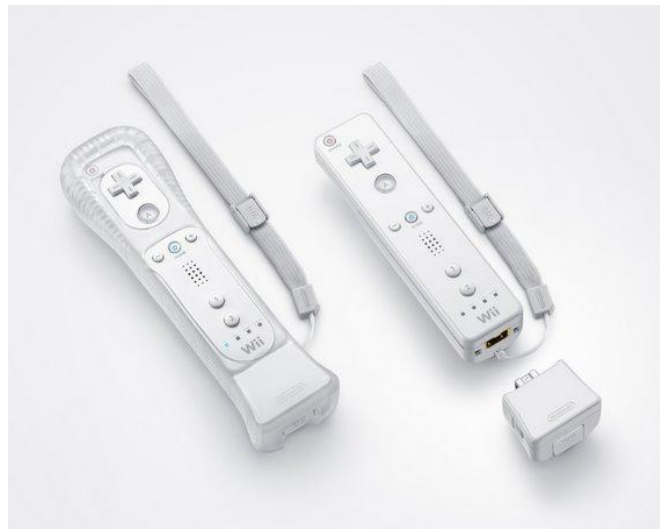
圖 1-6 任天堂 Wii 遊戲機的手把首先提出整合加速度計元件以及陀螺儀 [5]
