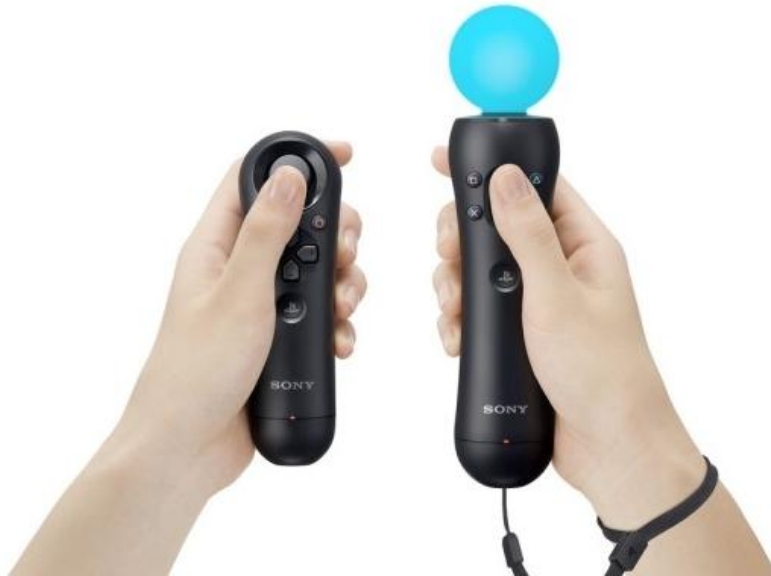
圖 1-7 PlayStation Move 動態控制器內建三軸陀螺儀、三軸加速度計與地磁力偵測器 [6]
