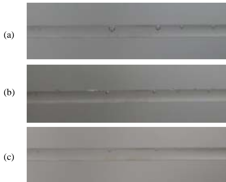
圖 3.3 蒸汽泡的冷卻測試：(a)室溫自然對流的情況 (b)使用冰浴冷卻 20 秒 (c)使用冰浴冷卻 60 秒
